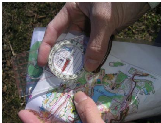
図4-3 プレートコンパスをセットした状態
