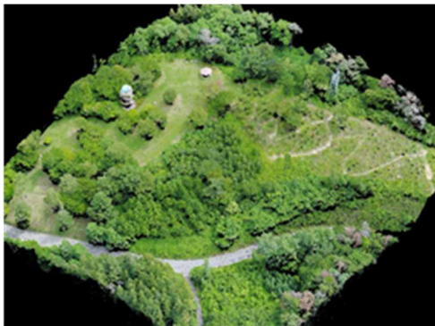
ドローン写真測量で作成した三次元データ (左)
