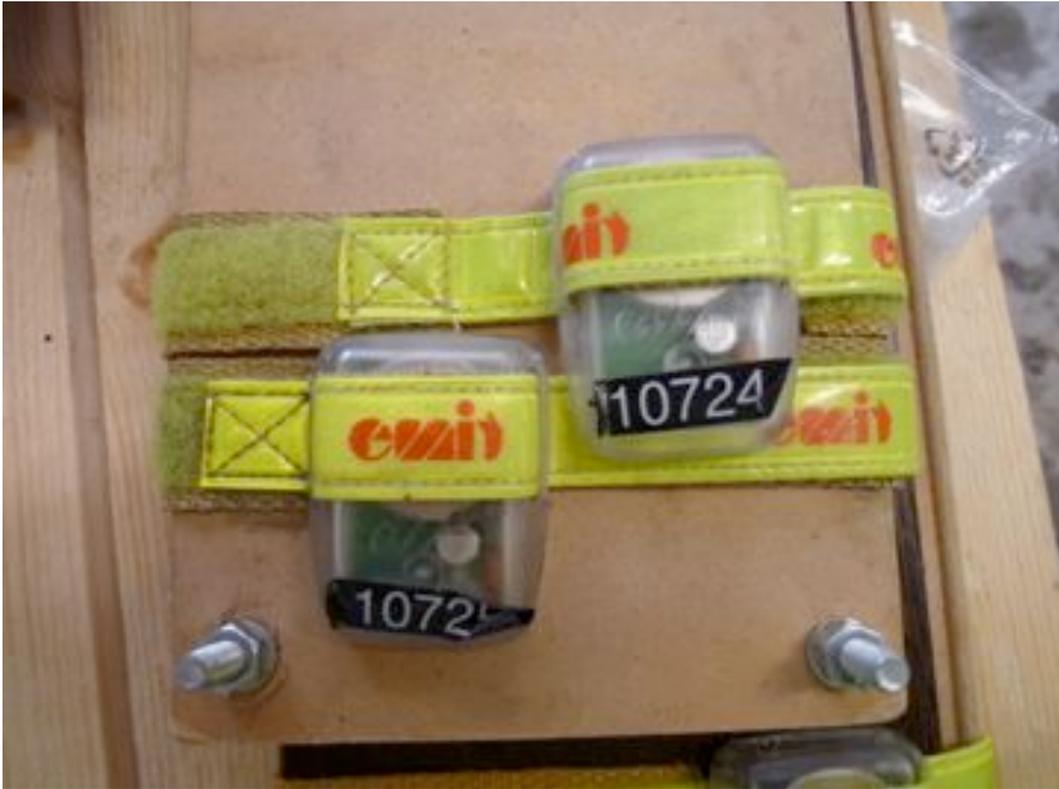
使用したチップ。コントロールでチェックすると LED が点滅する。故障時のバックアップ用に、選手は2つのチップを装着して競技する。
